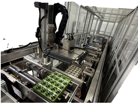
图2 宏观金相分析图像采集模块实物
