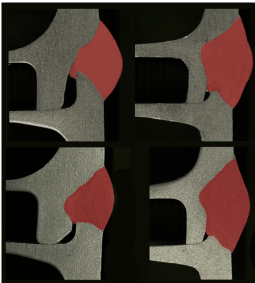
图9 图像样本及分割标注(沿基材区域与焊缝区域的交界进行精细标注,将焊缝区域完整覆盖)
